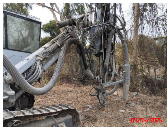
รูปที่ 20 รถเจาะระเบิดที่มีอุปกรณ์เก็บฝุ่นละอองติดไว้กับหัวเจาะ
